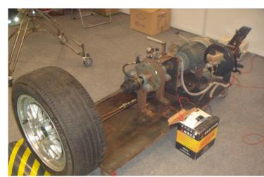
新式煞車系統實體圖
